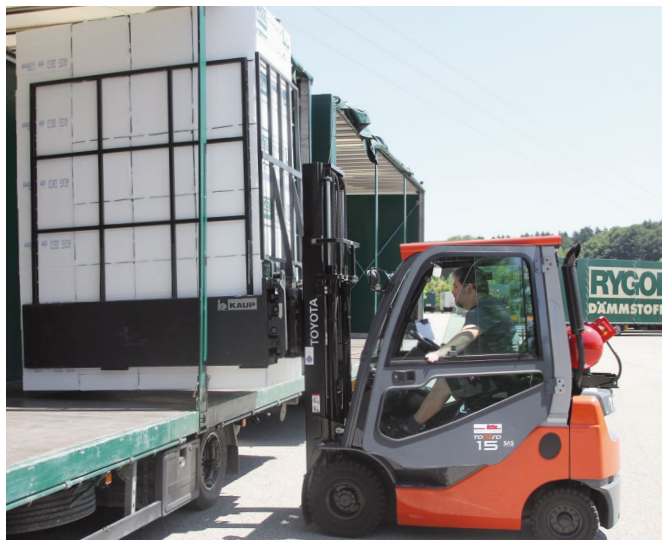
Einige der Stapler verfügen über speziell angefertigte Großflächenklammern vom Anbaugeräte-Experten Kaup. Diese sind im Vergleich zu den Standardklammern deutlich länger.
